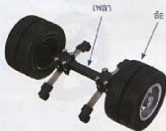
**ส่วนไฟฟ้า** เมื่อกดสวิตช์ใช้งาน ไฟฟ้าทำให้แกนขับเคลื่อนมอเตอร์หมุน โดยมีเฟืองช่วยลดความเร็ว การหมุนของมอเตอร์ลงทำให้แกนขับ (เพลลา) หมุนช้ากว่ามอเตอร์และส่วนหัวจับดอกส่วน (ล้อ) ที่ติดกับแกนกลับหมุนตาม
